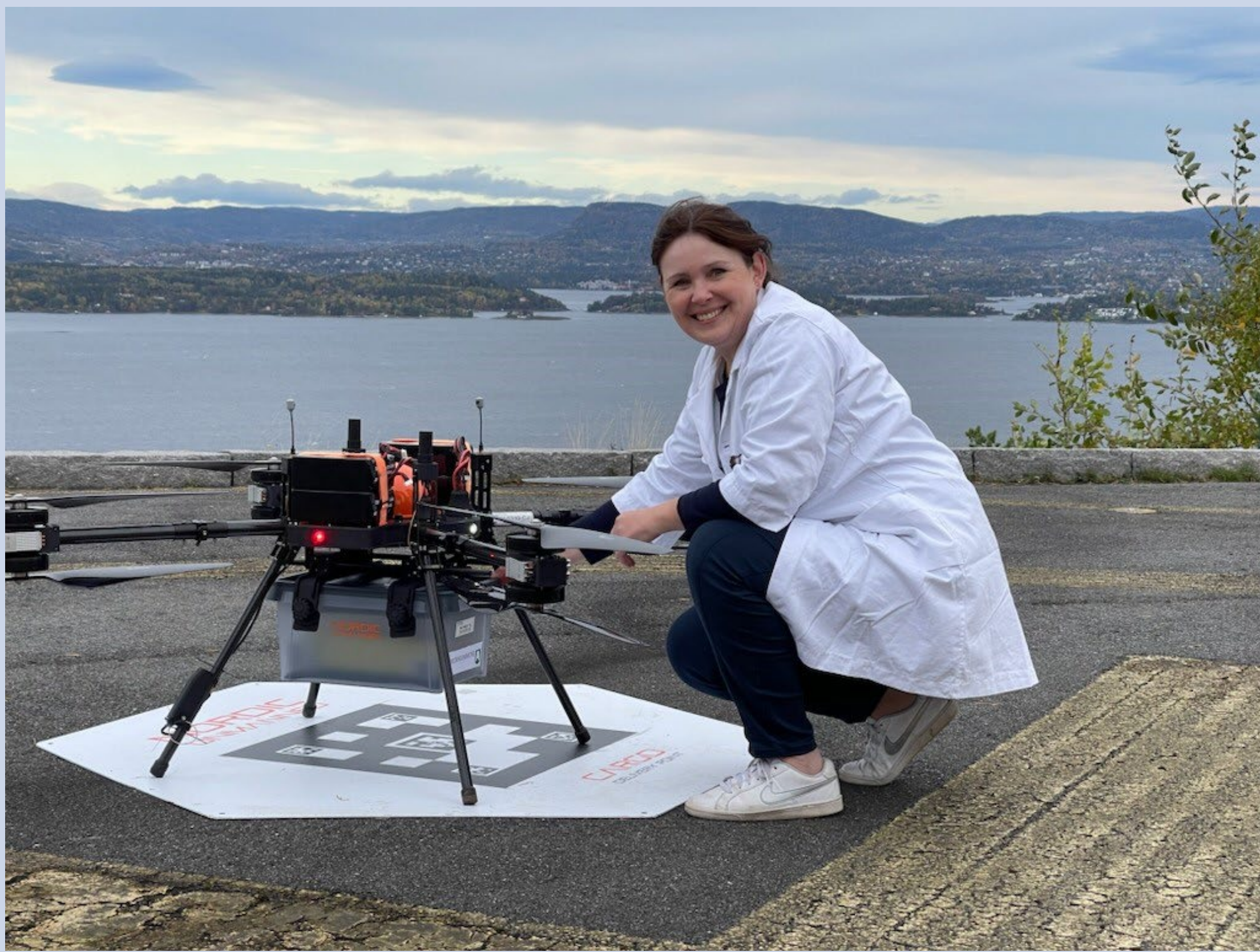
Firemotors drone med transportkasse festet under
